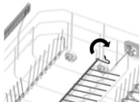
Inserts anti-goutte, permettant un meilleur séchage des assiettes. Vous pouvez les monter sur le panier ou dans la poche d'accessoires, auquel cas, il vous suffit, pour les utiliser, de les enfiler à l'emplacement prévu comme indiqué sur le schéma.
