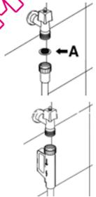
Dans les modèles dotés d'ACQUASTOP le filtre est déjà présent dans la bague fileté.
