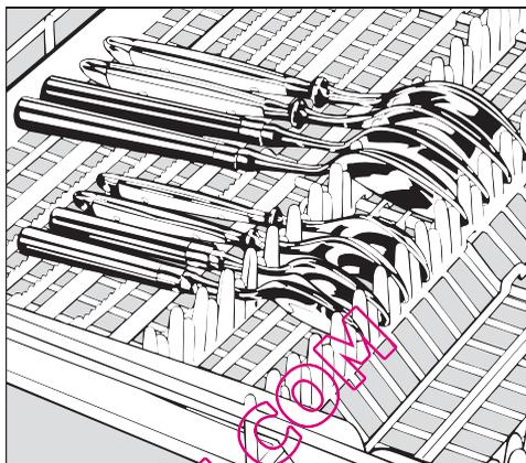
Lorsque les cuillers ne peuvent être insérées entre les supports, placez-les de sorte que les poignées reposent sur les supports dentelés.
