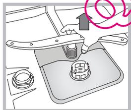
Pour démonter le bras supérieur, il faut dévisser la bague de fixation en plastique (tourner dans le sens inverse des aiguilles d'une montre). Il faut remonter le bras gicleur supérieur, orifices orientés
