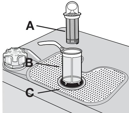
3. Desserrez le système de filtrage à l'aide de la poignée du microfiltre. Tournez la poignée dans le sens contraire des aiguilles d'une montre et effectuez 1/4 de tour pour enlever le système de filtrage
