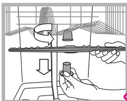
Pour démonter le bras supérieur, il faut dévisser la bague de fixation en plastique (tourner dans le sens inverse des aiguilles d'une montre).
