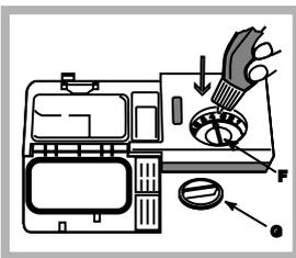
1. Ouvrir le réservoir en tournant le couvercle (G) dans le sens inverse des aiguilles d'une montre.
