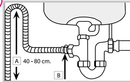
Le tuyau d'évacuation doit être placé entre 40 et 80 cm au-dessus du sol ou du plan d'appui du lave-vaisselle (A). Avant de raccorder le tuyau d'évacuation de l'eau au siphon de l'évier, retirer le bouchon en plastique (B).
