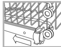
Ouvrir les butées des glissières du panier à droite et à gauche et sortir le panier. Positionner le panier en position haute ou basse, le faire glisser le long des glissières jusqu'à ce que les roues avant entrent elles aussi et refermer les butées (voir figure).
