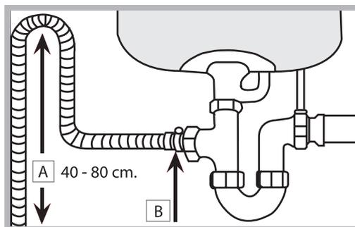
Le tuyau d'évacuation doit être placé entre 40 et 80 cm au-dessus du sol ou du plan d'appui du lave-vaisselle (A).
