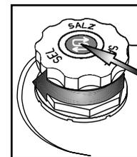
Vissez le bouchon. Éliminez les résidus de sel autour du bouchon. Certains réservoirs à sel ont un indicateur de niveau intégré dans le bouchon (voir comment contrôler ci-dessous).
